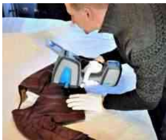
FT-IR analyse af tekstil med håndholdt FT-IR
